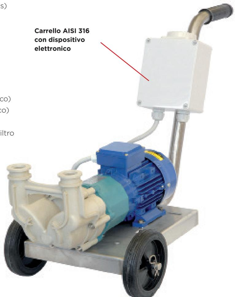
Carrello AISI 316 con dispositivo elettronico
