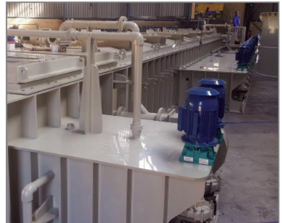
Pompe **EQUIPRO (HME)** installate in un impianto di decappaggio di cavi metallici (Sud Africa) per trasferire la soluzione elettrolitica dal serbatoio di stoccaggio alle vasche di decappaggio.
