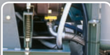
TENSIONATORE AUTOMATICO (KS 59-158) Per un corretto e costante funzionamento delle cinghie.
