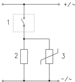
Applicazione in corrente continua ed alternata: i sensori Reed non sono protetti dalle sovratensioni generate da carichi induttivi, quindi si consiglia l'uso di circuiti soppressori di picchi di tensione. In figura è indicato un tipico esempio.
