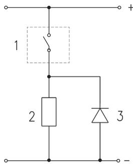
Applicazione in corrente continua: i sensori Reed non sono protetti dalle sovratensioni generate da carichi induttivi, quindi si consiglia l'uso di circuiti soppressori di picchi di tensione. In figura è indicato un tipico esempio.
