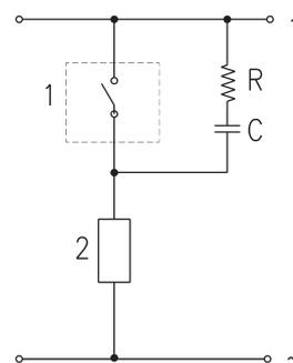
Applicazione in corrente alternata: i sensori Reed non sono protetti dalle sovratensioni generate da carichi induttivi, quindi si consiglia l'uso di circuiti soppressori di picchi di tensione. In figura è indicato un tipico esempio.
