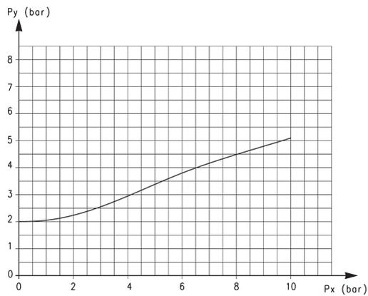
Il diagramma mostra la relazione fra la pressione di lavoro ( $P_x$ ) e la pressione necessaria per azionare la valvola ( $P_y$ ).
