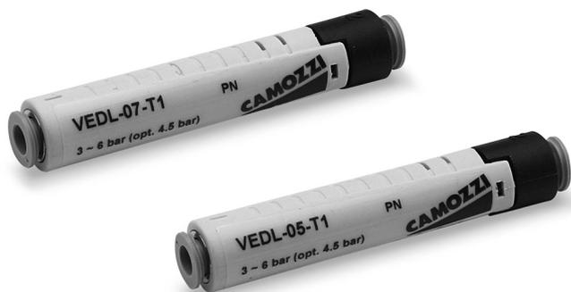
Di solito, questi eiettori per vuoto compatti sono montati direttamente tra la ventosa e l'alimentazione ad aria compressa per ridurre il volume da evacuare e permettere una sostanziale riduzione dei tempi di ciclo.
