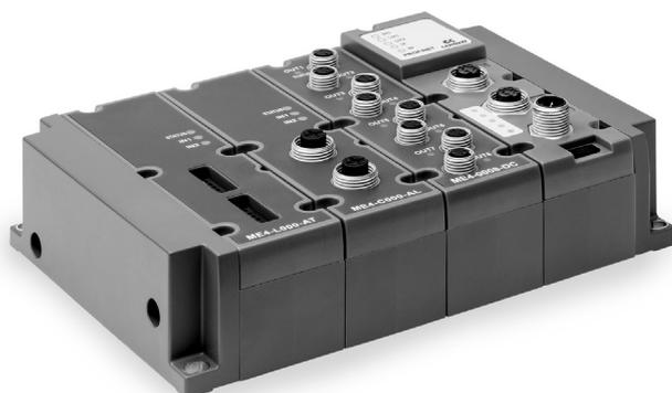
Il modulo multi-seriale Serie CX4, può essere interfacciato con i protocolli più diffusi come Profibus-DP, CANOpen, EtherCAT, EtherNet/IP, PROFINET
