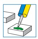
Forniscono giunzioni strutturali di **notevole tenacità**, **particolarmente resistenti** a trazione e a svariati agenti chimici. Sono indicati per incollare metalli, materiali ceramici, cemento, legno e alcune plastiche.
