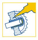
Gli adesivi di questa linea permettono il montaggio ad **alta** resistenza di un accoppiamento cilindrico quale: cuscinetti, ingranaggi, pulegge, perni, boccole.
