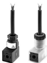
Il circuito raddrizzatore interno del connettore Mod. 125-900 permette l'utilizzo delle elettrovalvole con corrente alternata nelle varie tensioni, anche quando i dati di targa della elettrovalvola sono in corrente continua.
