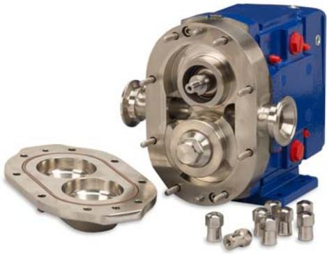
Le alette (pistoni) dei rotori Alfa Laval ruotano attorno alla circonferenza del canale nel corpo pompa. Ciò genera un vuoto parziale continuo alla bocca di aspirazione quando i rotori si disaccoppiano, provocando l'entrata del fluido nella pompa. Il fluido viene trasportato nel canale dalle alette del rotore e spostato quando le alette del rotore convergono, generando pressione sulla bocca di mandata. La direzione del flusso è reversibile.
