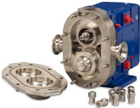
Le alette (pistoni) dei rotori Alfa Laval ruotano attorno alla circonferenza del canale nel corpo pompa. Ciò genera un vuoto parziale continuo alla bocca di aspirazione quando i rotori si disaccoppiano, provocando l'entrata del fluido nella pompa. Il fluido viene trasportato nel canale dalle alette del rotore e spostato quando le alette del rotore si riaccoppiano, generando pressione sulla bocca di mandata. La direzione del flusso è reversibile.
