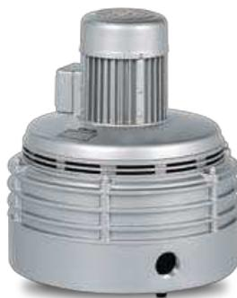
Drei- bis fünfstufige Radialgebläse für den Druckbetrieb mit Volumenströmen bis 9,3 m<sup>3</sup>/min und Unterdrücken bis 125 mbar. Kompakte Bauform, geringe Erwärmung auch im gedrosselten Betrieb. Schneller Hochlauf durch extrem leichte Laufräder. Die Motoren entsprechen DIN EN 60034 und sind in Schutzart IP 55 und Isolationsklasse F ausgeführt.
