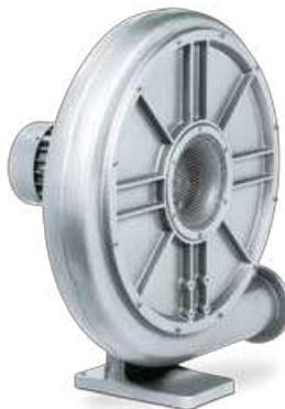
Radialgebläse für den Druckbetrieb mit Volumenströmen bis 18,6 m<sup>3</sup>/min und Überdrücken bis 29,7 mbar. Stabile Leichtbauweise nach dem Baukastenprinzip, schwingungsfreier, geräuscharmer Lauf, wartungsfrei durch Dauerfettschmierung. Die Motoren entsprechen DIN EN 60034 und sind in Schutzart IP 55 und Isolationsklasse F ausgeführt.
