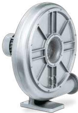
Radialgebläse für den Druckbetrieb mit Volumenströmen bis 22,1 m<sup>3</sup>/min und Überdrücken bis 83,4 mbar. Stabile Leichtbauweise nach dem Baukastenprinzip, schwingungsfreier, geräuscharmer Lauf, wartungsfrei durch Dauerfettschmierung. Die Motoren entsprechen DIN EN 60034 und sind in Schutzart IP 55 und Isolationsklasse F ausgeführt.
