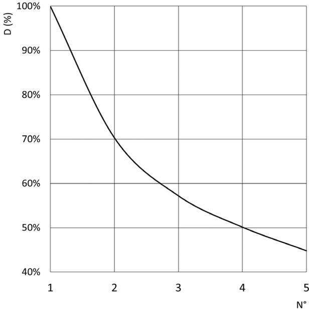
N = N° di valvole montate in manifold
