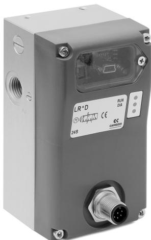
Le servo valvole digitali proporzionali Serie LR sono valvole 3/3 vie ad azionamento diretto, dotate di un sistema brevettato basato sul principio della spola rotante con controllo elettronico della posizione della spola a circuito chiuso. La scheda elettronica è integrata direttamente nel corpo della valvola.
